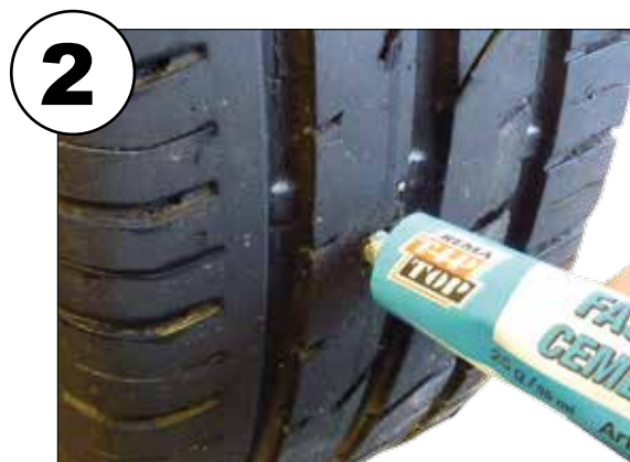
Skadeskanalen påføres REMA TIP TOP Special-cement.
