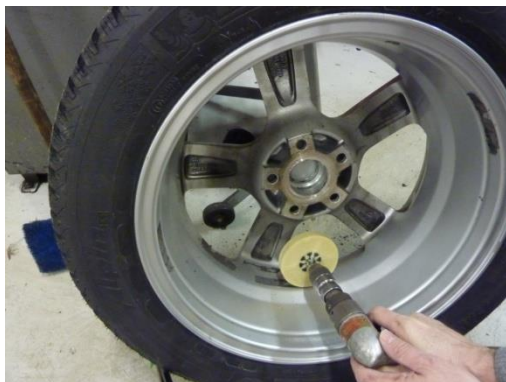
Fjern limrester med roterende gummiskive.
