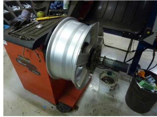
Spæn fælgen op i balancemaskinen på korrekt vis: Konus bagfra og trykflange forfra. Brug aldrig konus forfra. Sørg for rene anlægsflader. Indgiv hjul data og sæt balancemaskinen i statisk mode.
