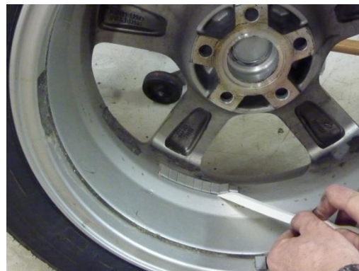
Fjern gamle vægte. Brug ikke kniv til alu-fælge, men anvend en skarp fiber spartel.
