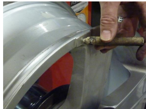
Sæt en markering på fælgen i kl.12 position.
