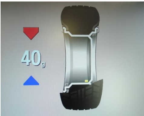
Spin fælgen: Resultatet her 40g statisk for fælgen alene. Hvilket svarer til 0,4 % for et fælg på 10 Kg.
